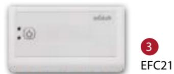
Le contrôleur EFC21 est le garant de votre sécurité. Lorsque le Gyrofocus gaz est allumé, un signal est envoyé à l'extracteur pour créer un tirage optimal dans le conduit de fumée. Lorsque le tirage est établi, le contrôleur permet l'alimentation gaz au brûleur. Si le contrôleur détecte un défaut de tirage, il coupe l'alimentation gaz et le Gyrofocus gaz s'arrête immédiatement. C'est le seul système sur le marché qui a obtenu l'homologation GASTEC conformément à la norme EN298.
